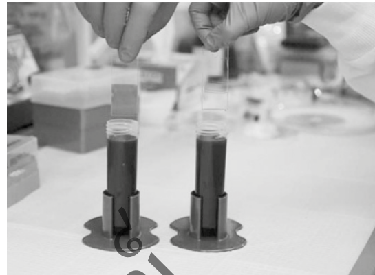
ภาพแสดงการไหลและเกาะติดของเลือดบนพื้นผิวที่ไม่ได้เคลือบผิว (ซ้าย) และพื้นผิวที่เคลือบด้วยเทคนิค TLP (ขวา) ซึ่งจะเห็นความแตกต่างได้อย่างชัดเจน [3]
